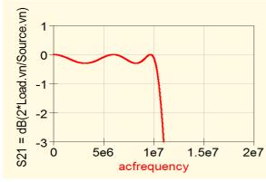
Mit einem Frequenzbereich von 0....20 MHz und einem Amplitudenbereich von +1....-3 dB sieht das dann so aus, wie wir wollen.....
